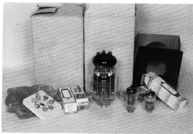
【写真2】 キットに付属する真空管 (片チャンネル分)
