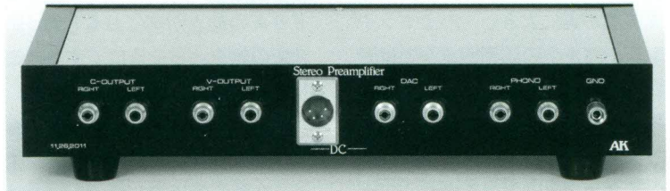
本機は実験用に電圧出力と電流出力の両方の端子を備えているが、実際に製作する場合は電流出力だけでよい
